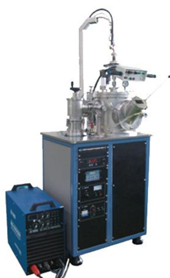
真空电弧炉设备
